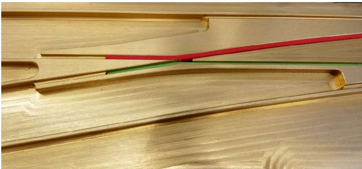
Figuur E.3 Het puntstuk van een WIRAS-wissel
